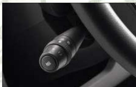
**Regolatore di velocità.** Il regolatore di velocità consente di mantenere il veicolo alla velocità prescelta, senza azionare l'acceleratore e indipendentemente dalle condizioni del rilievo.
