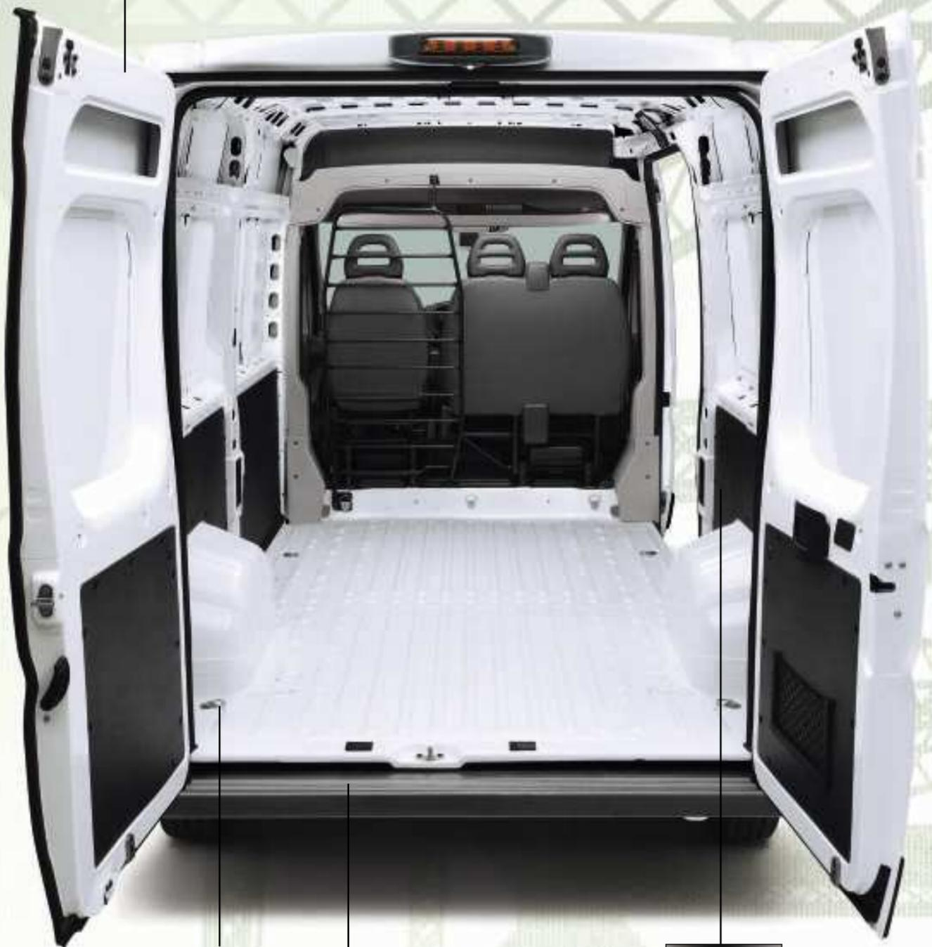
**Anelli per assicurare il carico.** Il pavimento zigrinato per facilitare lo spostamento dei carichi è dotato di 8 anelli (10 nei veicoli più lunghi) per ancorare perfettamente il carico.
