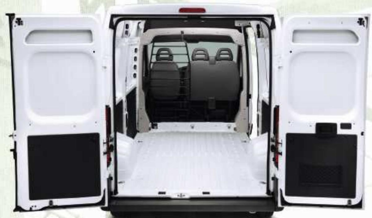
Fornito di serie con due porte posteriori a battente con chiusura su 4 punti, Citroën Jumper rivela con un solo gesto l'insieme del volume interno, per ottimizzare il carico senza vincoli. Per tutti i furgoni di qualsiasi dimensione la larghezza dei battenti posteriori corrisponde all'intera larghezza utile all'interno.
